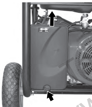
Демонтаж на капака на въздушния филтър
